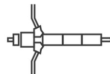
La tecnología I-ART mejora la precisión y eficiencia de la inyección de combustible al integrar una memoria electrónica en el inyector para controlar la presión.
